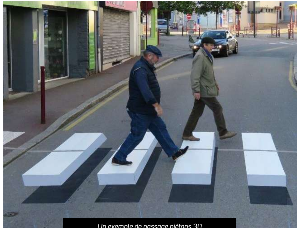
Un exemple de passage piétons 3D
