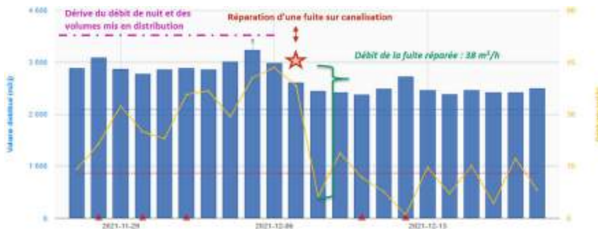
Figure : Evolution des volumes mis en distribution et des débits de nuit sur le secteur d'Eragny Sud du 27/11/2021 au 18/12/2021. Visualisation de l'impact de la réparation de la fuite sur canalisation du 07/12/2021 sur le débit de nuit du secteur.
