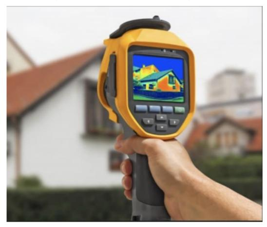
Identifier les ponts thermiques et les problèmes d'étanchéité, c'est désormais possible grâce à une caméra thermique.
